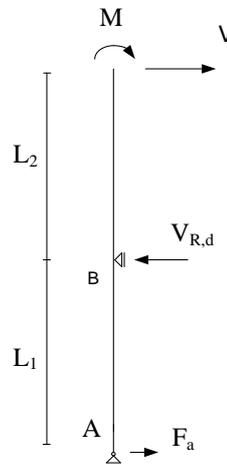
Abbildung 3: Statisches System der "S + P" Stockschrauben
