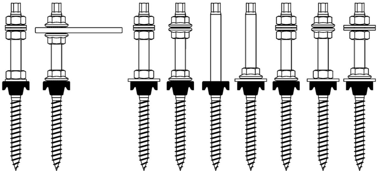
"S + P" Stockschrauben zur Befestigung von Anbauteilen, insbesondere von Aufständerungen oder von Tragprofilen von Solarmodulen
