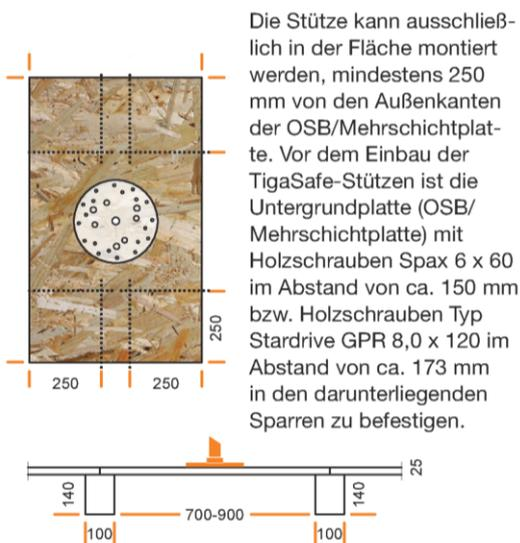
Die Stütze kann ausschließlich in der Fläche montiert werden, mindestens 250 mm von den Außenkanten der OSB/Mehrschichtplatte. Vor dem Einbau der TIGA-Safe-Stützen ist die Untergrundplatte (OSB/Mehrschichtplatte) mit Holzschrauben Spax 6 x 60 im Abstand von ca. 150 mm bzw. Holzschrauben Typ Stardrive GPR 8,0 x 120 im Abstand von ca. 173 mm in den darunterliegenden Sparren zu befestigen.
