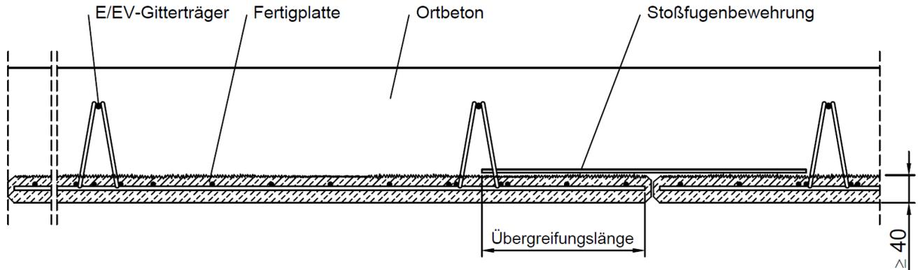
**Bild 5: Streifenelemente mit Betonstahl**
