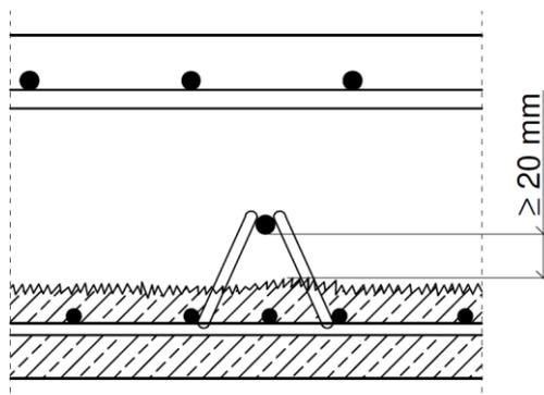
**Bild 11: Gitterträger als Verbund- und Querkraftbewehrung (mäßige Beanspruchung)**
