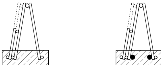
Bild 23: DH- bzw. EH-Gitterträger als Verbund- und Schubzulagen
