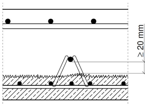
**Bild 8: Gitterträger als Verbund- und Querkraftbewehrung (mäßige Beanspruchung)**
