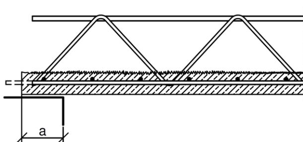
**Bild 4b: Auflagerung mit Montageunterstützung am Rand**
