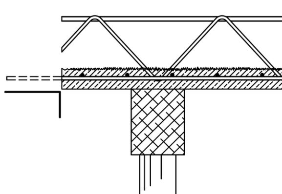
Auflagerung ohne Montageunterstützung am Rand, wenn  $a \geq 35\text{mm}$  ist und die Bedingungen nach Abschnitt 3.2.2 erfüllt sind.
