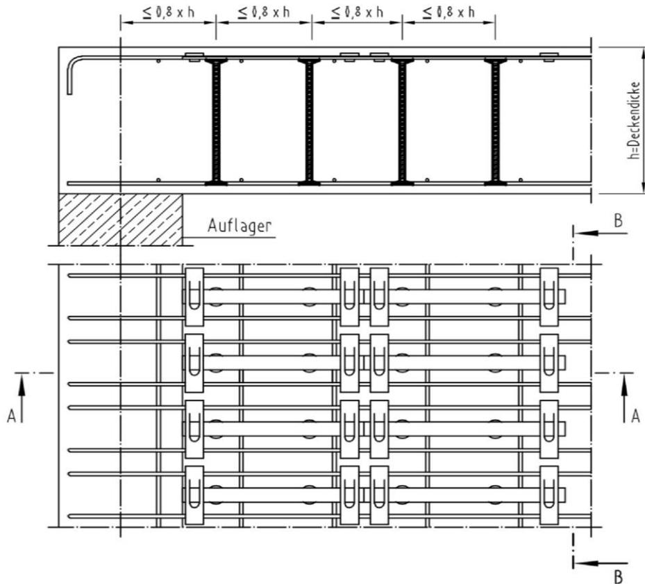
Achsabstände der Anker quer zur Haupttragrichtung nach Anlage 11, Tabelle 2
