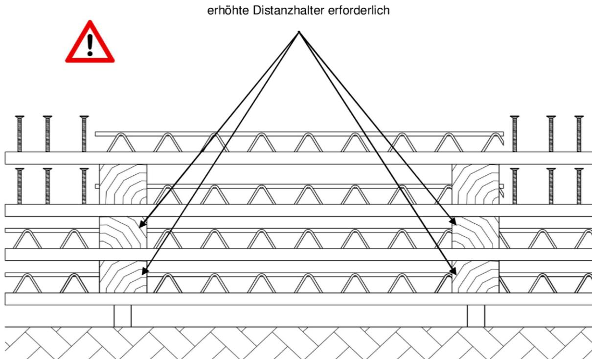
Beim Lagern und Transportieren von Elementdecken sind die Bewehrungselemente zu beachten, die aufgrund ihrer Höhe über die Gitterträger hinausragen. Die zur Auflagerung der Elementdecken erforderlichen Distanzhalter sind entsprechend zu erhöhen.
