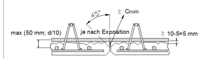
Erforderliche Betondeckung für eine Bewehrung in Elementwänden nach DIN EN 1992-1-1 mit DIN EN 1992-1-/NA
