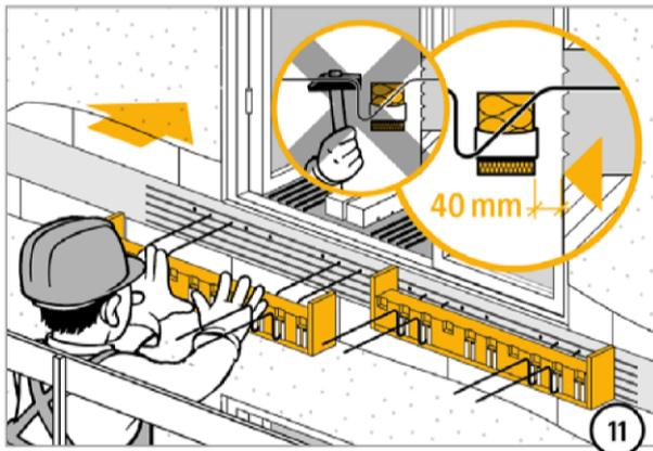
Nach der Bohrlochreinigung erfolgt der trockene Einbau des Schöck Isokorb® zu Kontrollzwecken. Der Schöck Isokorb® muss ohne großen mechanischen Kraftaufwand einsetzbar sein.
