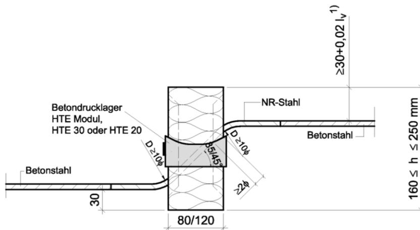
Abb. 17 Schöck Isokorb Typ RQ-240 mit Betondrucklager
