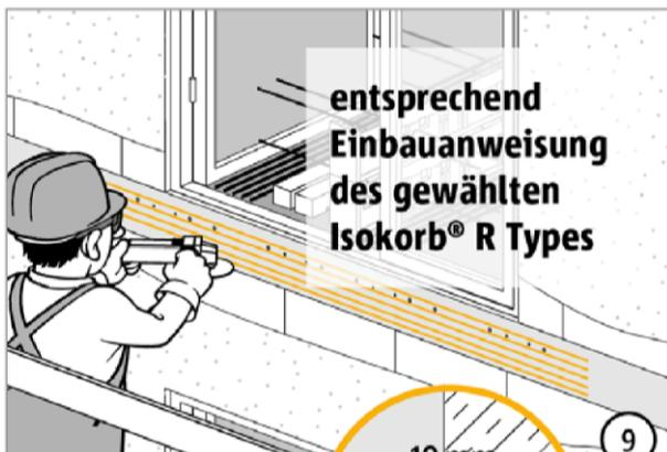
Im Bereich des Schöck Isokorb® muss die Stirnseite der Bestandsdecke entsprechend nebenstehender Skizze nach DIN EN 1992-1-1 und DIN EN 1992-1-1/NA bearbeitet werden.
