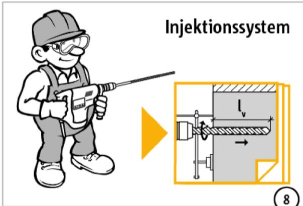
Die Bohrung muss mit dem Hammerbohrverfahren mit Bohrhilfe bzw. Diamantbohrverfahren nass mit Bohrhilfe nach den Setzanweisungen des entsprechenden Injektionssystems durchgeführt werden.
