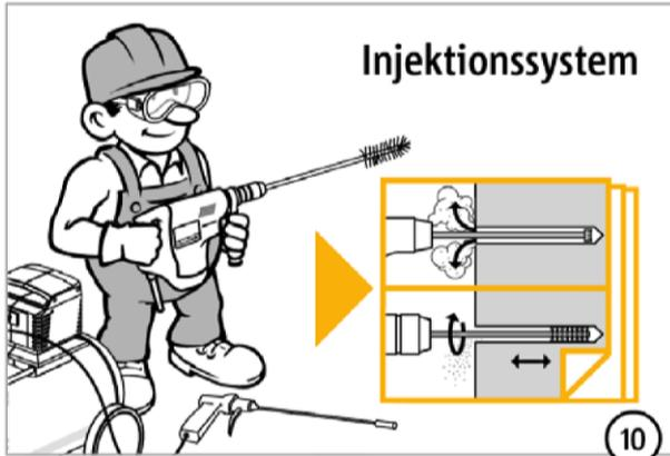
Entsprechend den technischen Anweisungen des entsprechenden Injektionssystems muss jedes Bohrloch gereinigt werden.
