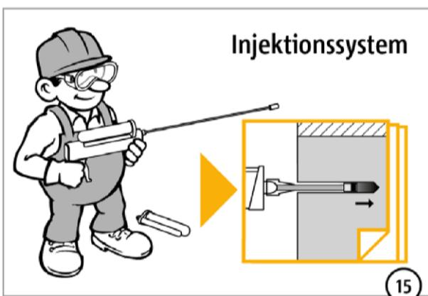
Das Bohrloch muss luftblasenfrei mit Injektionsmörtel nach der Setzanweisung des entsprechenden Injektionssystems verfüllt werden.
