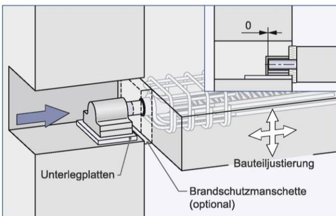
Anschließend wird das Lageresement vollständig auf den eingeschraubten Gewindebolzen aufgeschoben. Durch Unterlegplatten kann das Lageresement unterfüttert werden.
