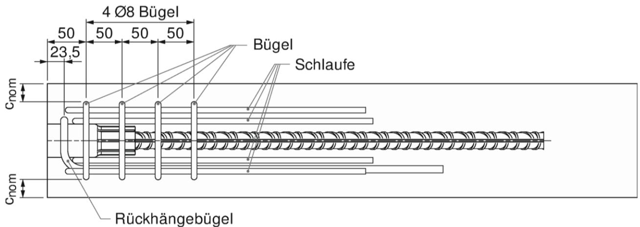
Bild 10: Bauseitig vorzusehende Bewehrung im eingebauten Zustand
