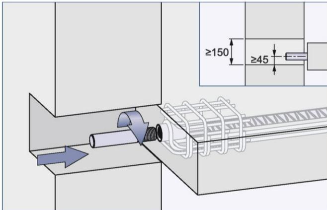
Zunächst ist das Bauteil, in dem die Gewindeanker einbetoniert sind, entsprechend der Endposition auszurichten und zu unterstützen
