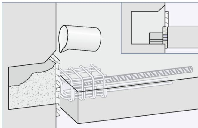
Der Verguss der Aussparung mit Vergussmörtel in der Auflagerwand ist notwendig, um die Dauerhaftigkeit des Auflagers sicher zu stellen. Hierbei ist darauf zu achten, dass beim Verguss der Aussparung keine Schallbrücken entstehen.
