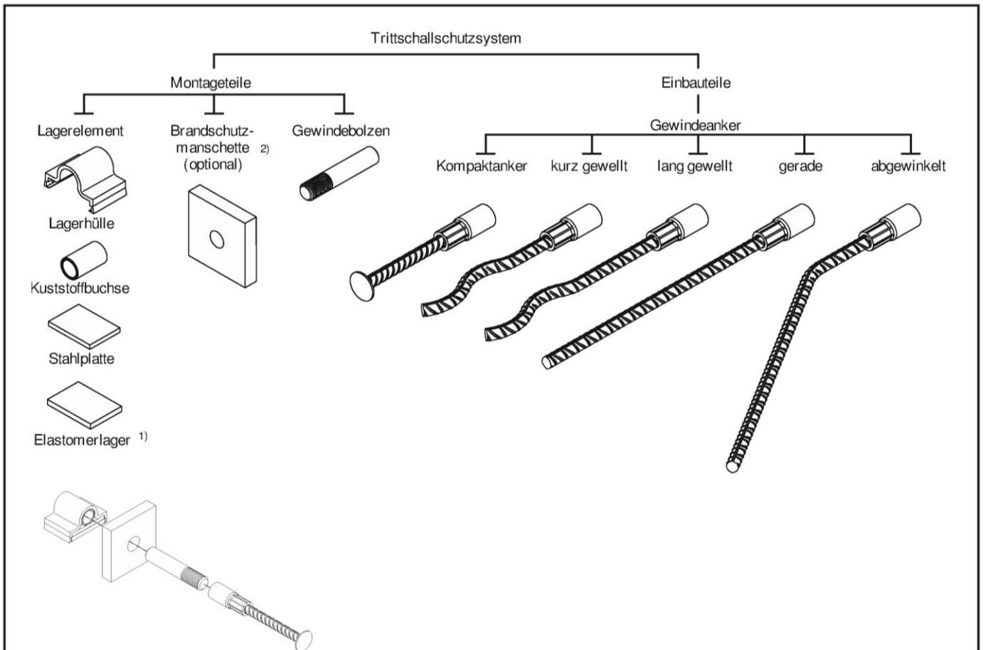
Bild 1: Systemübersicht, Bezeichnung der einzelnen Bestandteile, Explosionszeichnung (unten)
