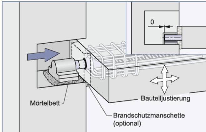
Alternativ zu Unterlegplatten kann auch ein Mörtelbett als Unterstützung des Lagerelementes dienen. Bei Verwendung der Brandschutzmanschette ist diese vor dem Aufschieben des Lagerelementes auf den Bolzen zu stecken.
