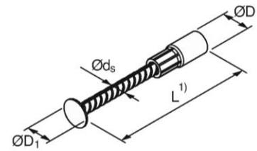
Bild 4: Kompaktanker
