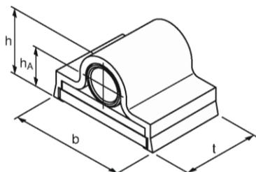
Bild 2: Lagerelement (wird zusammengebaut geliefert)
