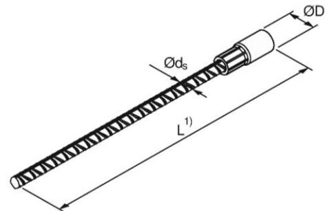
Bild 6: Gewindeanker gerade
