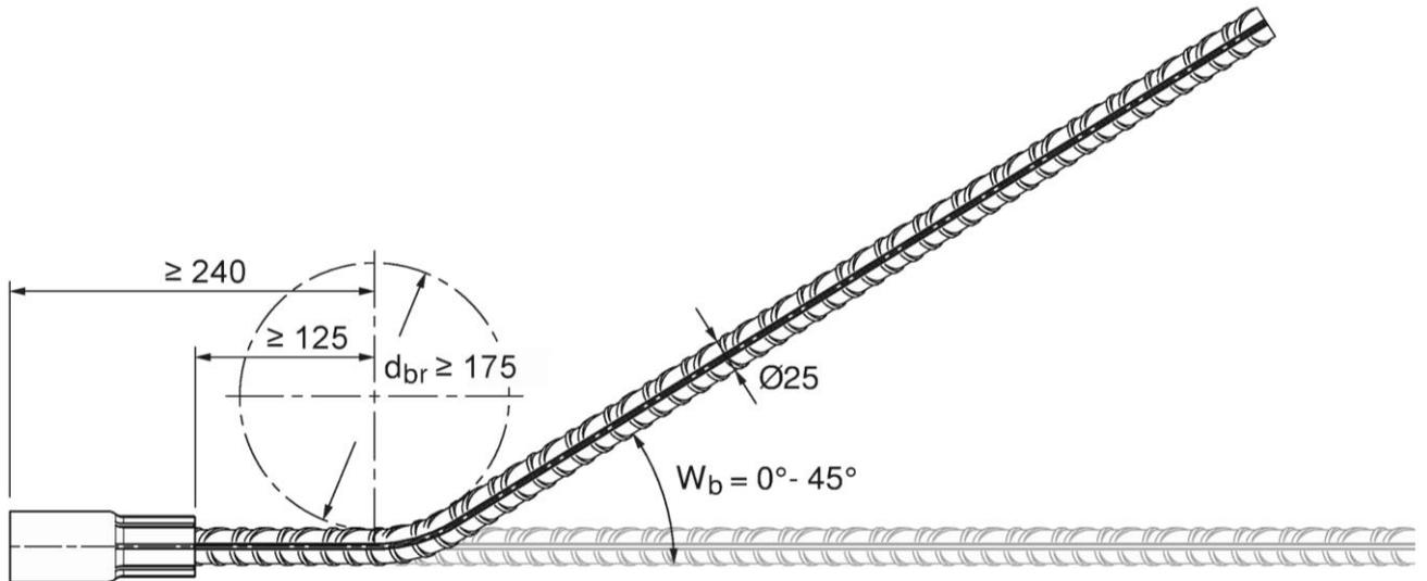
Bild 13: Biegen der Gewindeanker Ausführung gerade (vgl. Anlage 3) durch den Anwender
