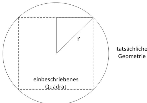
Abbildung 1: Ansetzbare Fläche bei runden Lagern zur Ermittlung des Formfaktors S<sub>mod</sub>.
