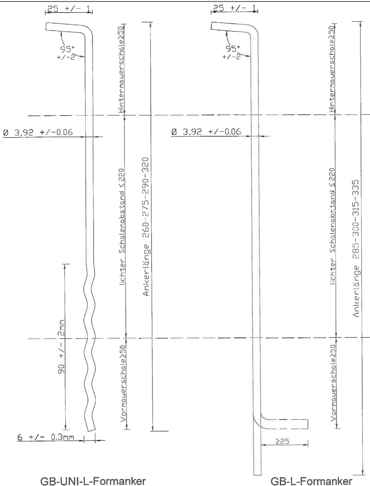
Drahtanker mit Durchmesser 4 mm
