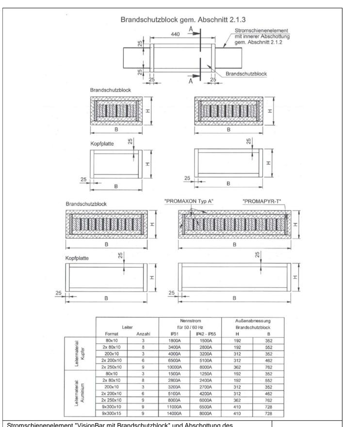
Stromschienenelement "VisionBar mit Brandschutzblock" und Abschottung des Stromschienensystems "VisionBar"
