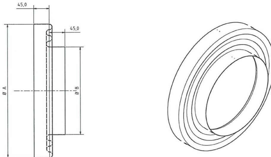
Ø A = Ø des in der Wand angeordneten Hüllrohrs
