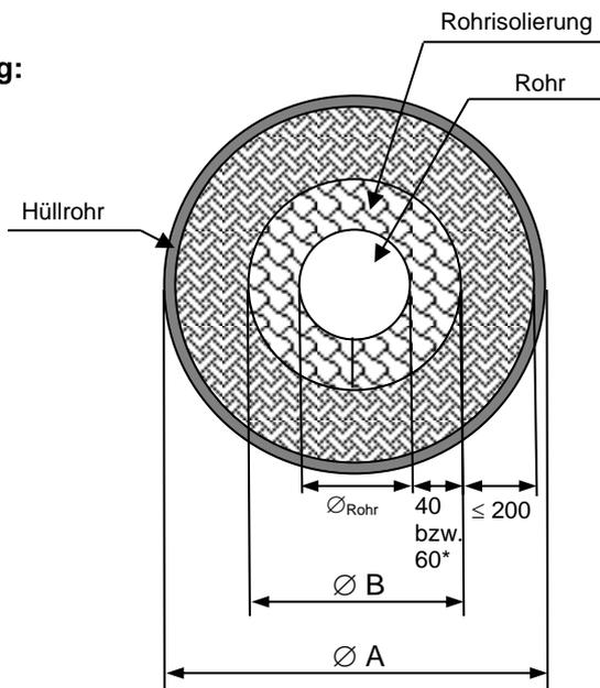
\* Bei Rohrdurchmessern > 406,4 - 813,0 mm
