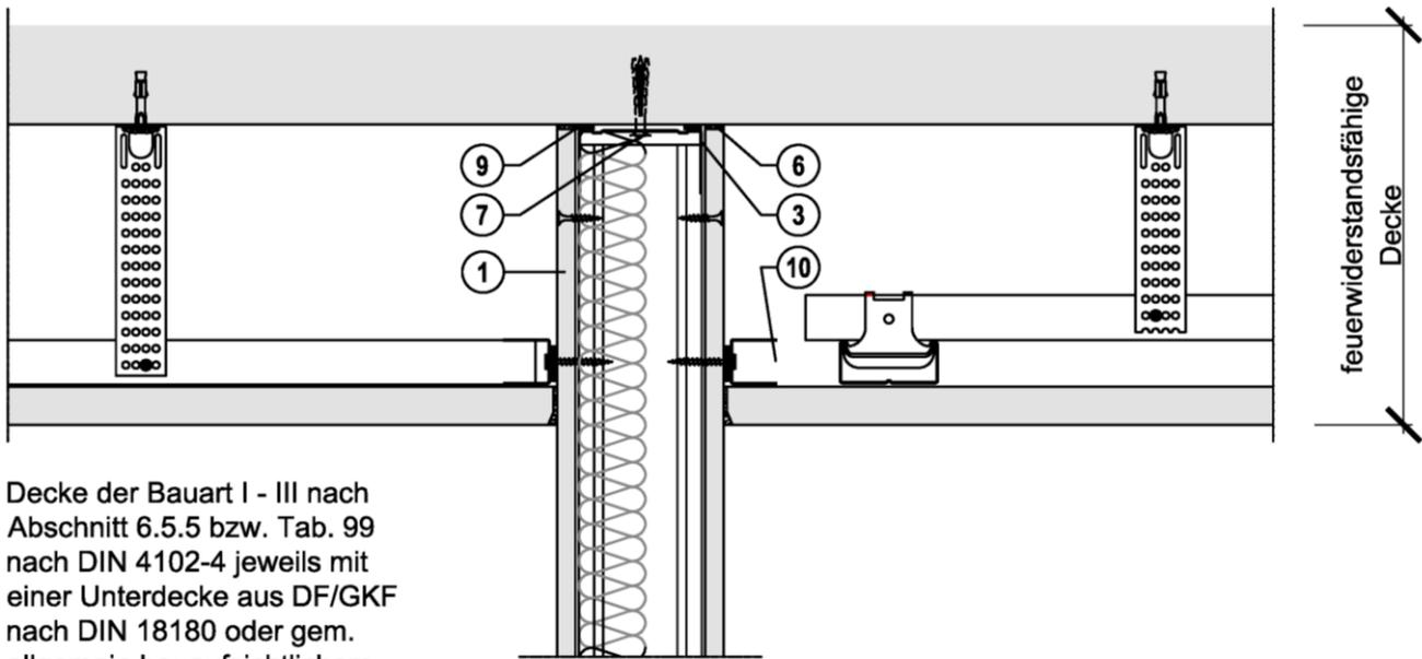
Decke der Bauart I - III nach Abschnitt 6.5.5 bzw. Tab. 99 nach DIN 4102-4 jeweils mit einer Unterdecke aus DF/GKF nach DIN 18180 oder gem. allgemein bauaufsichtlichem Prüfzeugnis mit einer Unterdecke aus Gipsplatten gleicher oder höherer Feuerwiderstandsklasse
