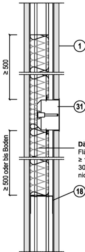
**Dämmstoff, Schmelzpunkt  $\geq 1000$  °C**
