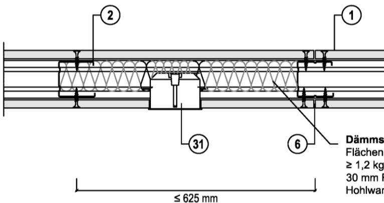
**Dämmstoff, Schmelzpunkt  $\geq 1000$  °C**
