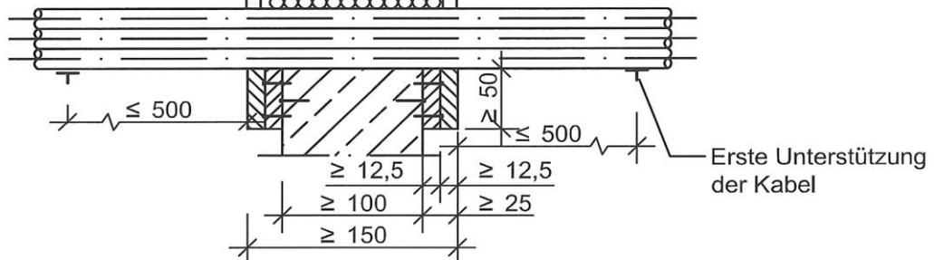
**Variante 2 - 100 mm Schottdicke mit Wickel an den Kabelbündeln**
