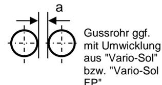
Der Abstand a wird zwischen den Umwicklungen mit dem dämmschichtbildenden Baustoff ("Vario-Sol" bzw. "Vario-Sol FP") im Bereich der Decke gemessen.
