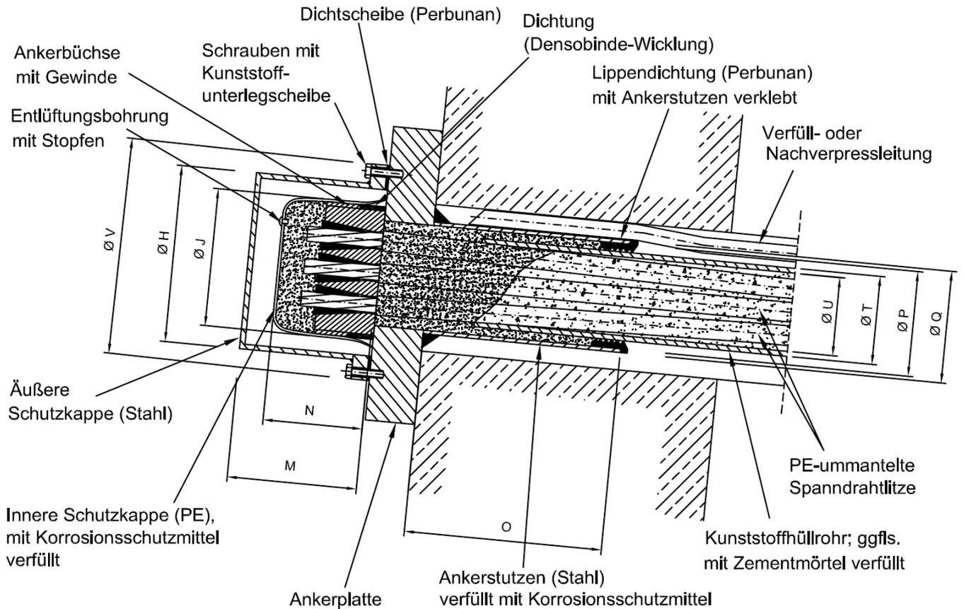
Bei den Typen 6-15 bis 6-22 hat der Ankerstutzen ein Reduzierstück (Stahl) für die Lippendichtung.
