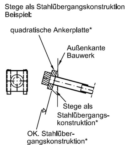
\* Die Bemessung der Ankerplatte und Stahlübergangskonstruktion erfolgt durch Nachweis.
