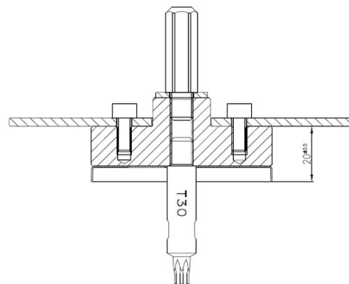
**Bild 3.2:** ejotherm STR U Montagewerkzeug Typ "S" für Dämmstoffdicken ab 80 mm
