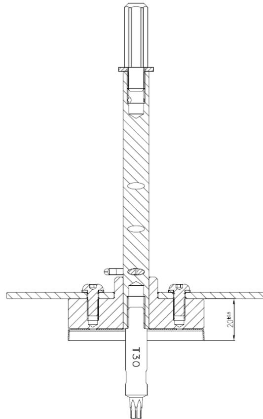
**Bild 3.4:** ejotherm STR U 2G Montagewerkzeug Typ "S"
