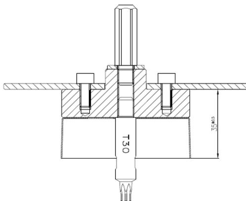
**Bild 3.1:** ejotherm STR U Montagewerkzeug Typ "L" für Dämmstoffdicken ab 100 mm
