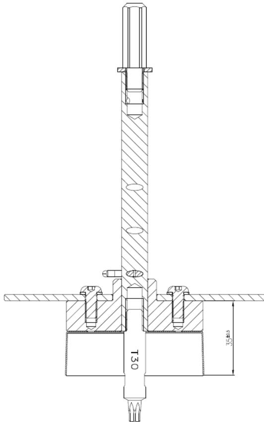
**Bild 3.3:** ejotherm STR U 2G Montagewerkzeug Typ "L"
