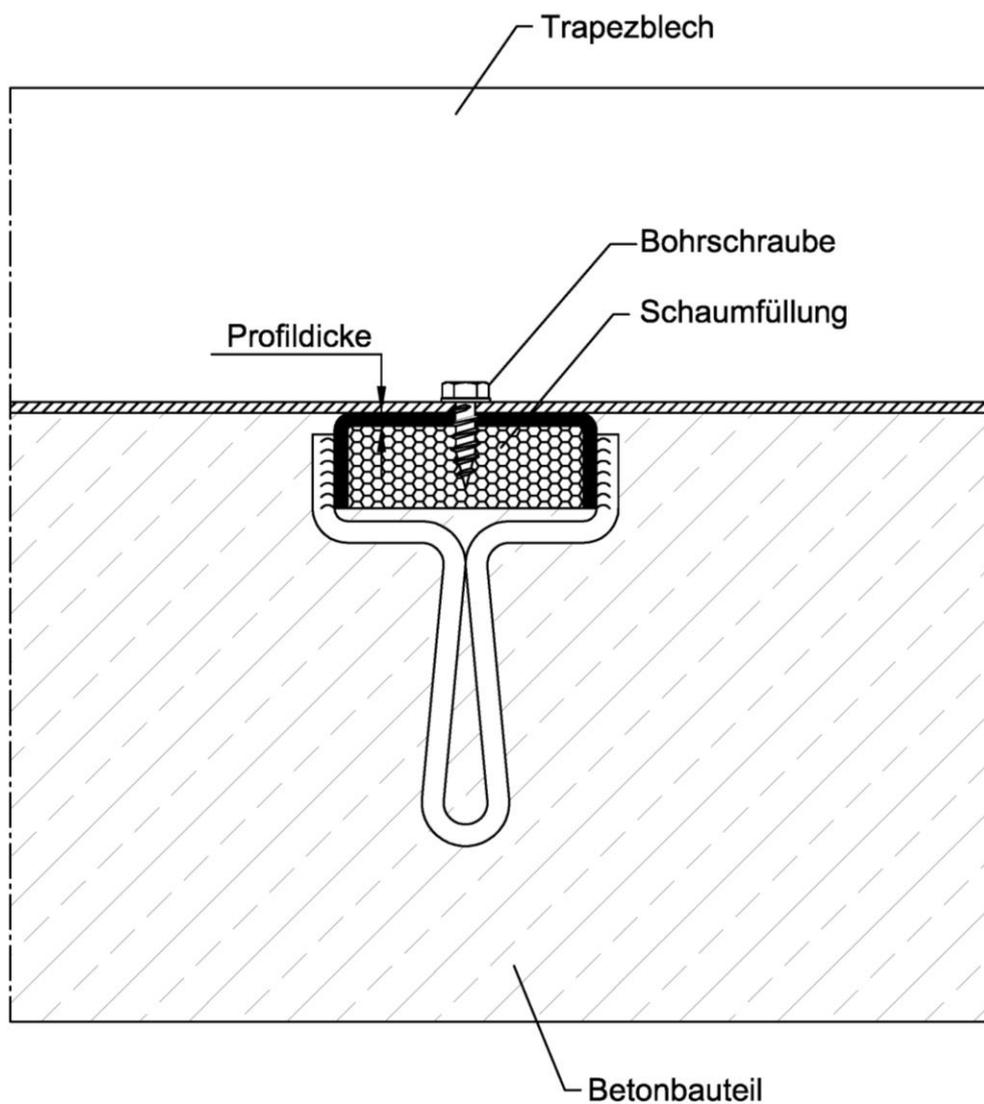
Halben Trapezblechbefestigungsschienen HTU 60/22/3 und HTU 60/22/6
