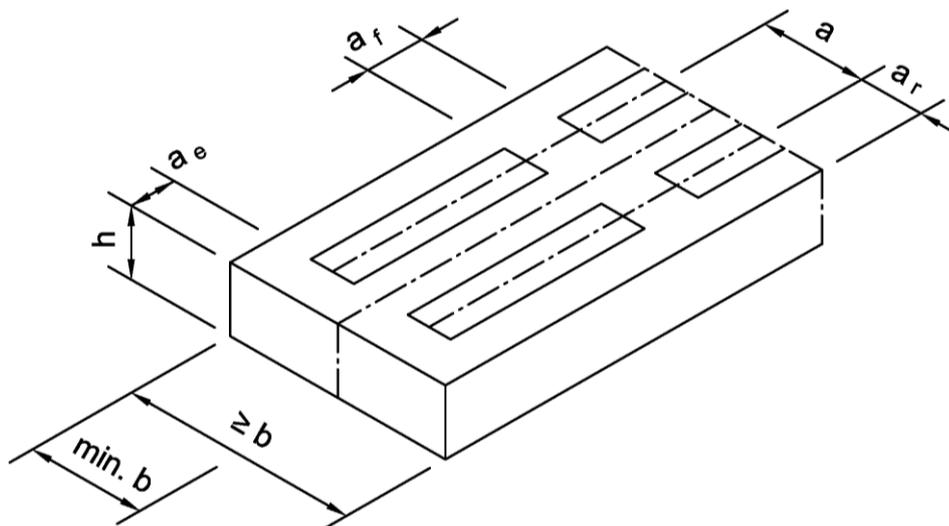
Halben Trapezblechbefestigungsschienen HTU 60/22/3 und HTU 60/22/6
