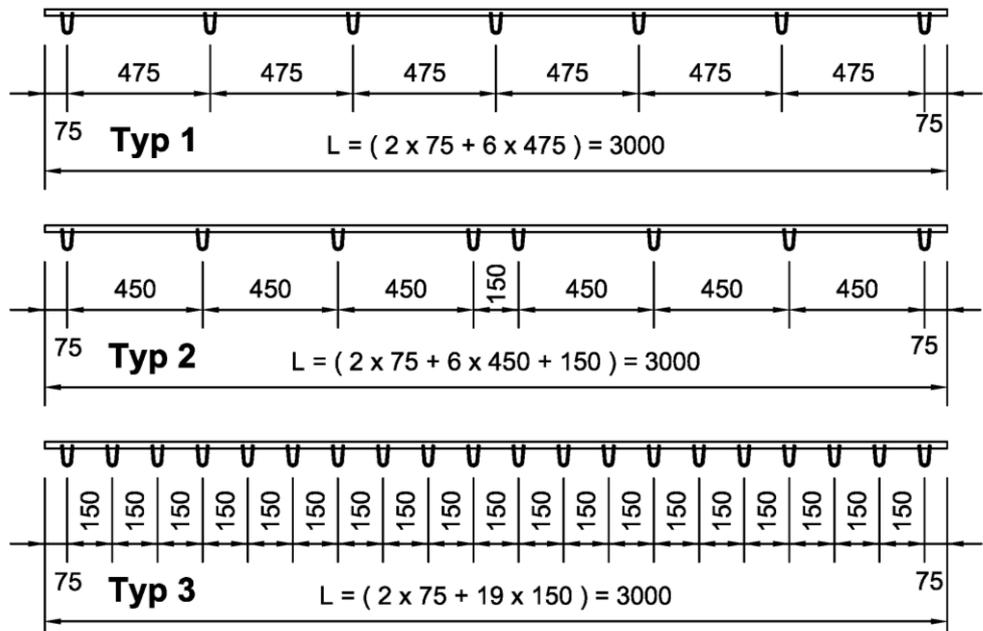
Halfen Trapezblechbefestigungsschienen HTU 60/22/3 und HTU 60/22/6
