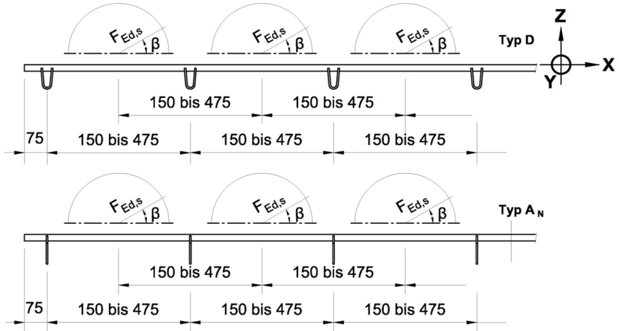
Die Zulässigkeit der vorhandenen Einwirkungen auf die Schiene ist durch einen statischen Nachweis für einen durch Einzellasten der Schrauben  $F_{Ed,s}$  beanspruchten Einfeld- oder Mehrfeldträger mit frei drehbar angenommenen Auflagern zu ermitteln. Der resultierende Bemessungswert der Einwirkung auf den Anker res.  $F_{Ed}$  darf den Bemessungswert des Widerstandes  $F_{Rd}$  nach unten aufgeführter Tabelle nicht überschreiten.
