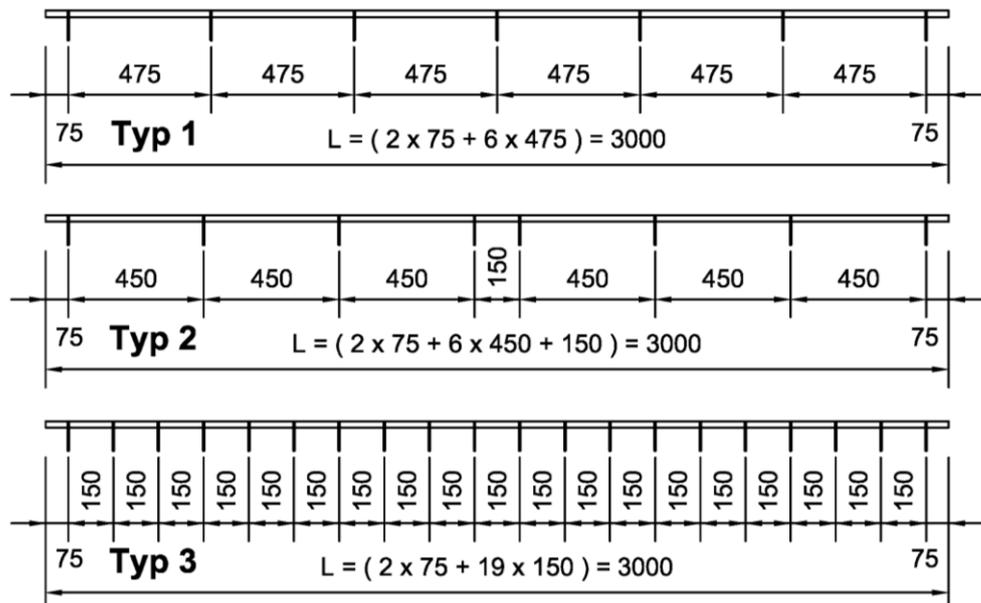
Halfen Trapezblechbefestigungsschienen HTU 60/22/3 und HTU 60/22/6
