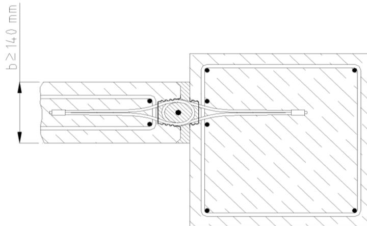
Bild 6: Stützen - Wandverbindung
