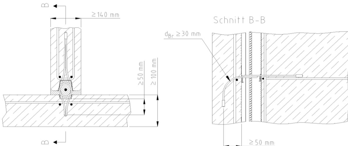
Bild 10: Wand - Wand – T-Verbindung - Detail bei abgewinkelter Seilschleufe
