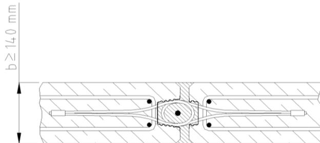
Bild 5: Wand - Wandverbindung
