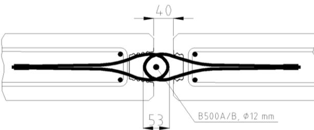
Bild 14: Maximale Fugenbreite
