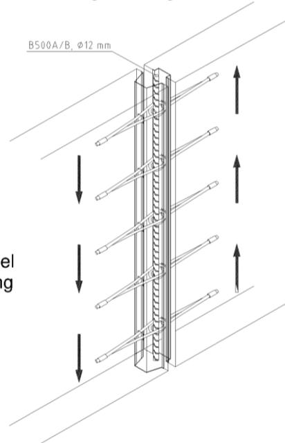
Bild 18: Beanspruchung parallel zur Fugenlängsrichtung
