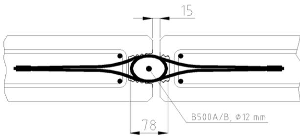
Bild 13: Minimale Fugenbreite
