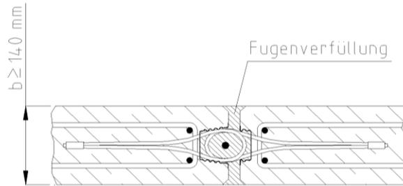
Bild 5: Wand - Wandverbindung
