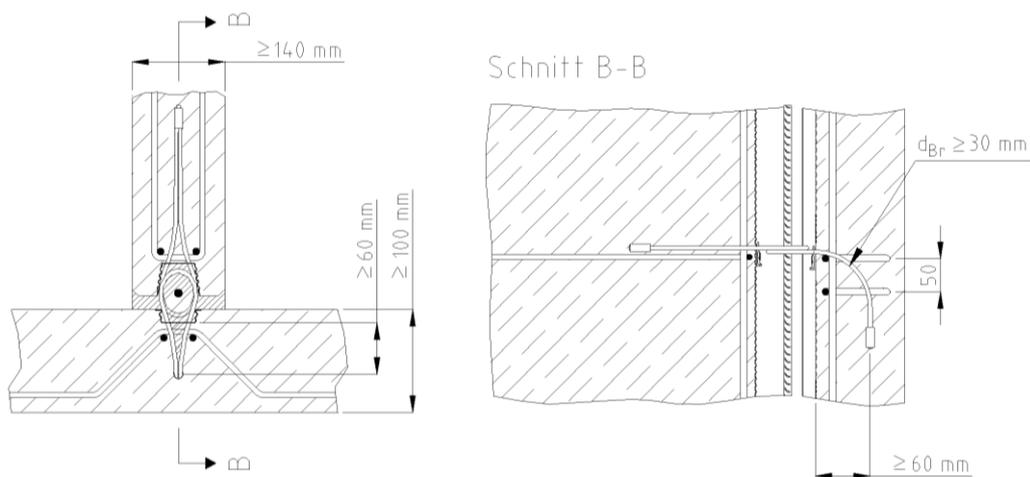
Bild 10: Wand - Wand – T-Verbindung - Detail bei abgewinkelter Seilschleife
