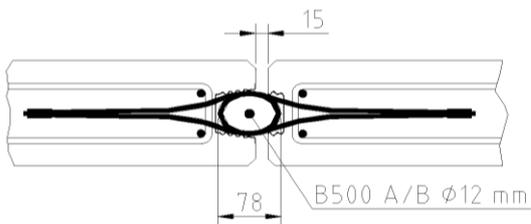
Bild 13: Minimale Fugenbreite
