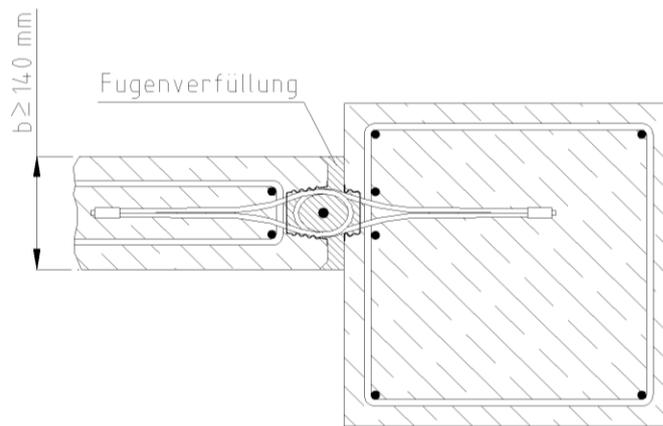
Bild 6: Stützen - Wandverbindung
