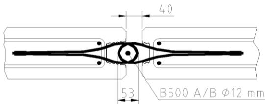
Bild 14: Maximale Fugenbreite
