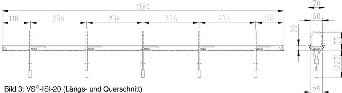
Bild 3: VS®-ISI-20 (Längs- und Querschnitt)
