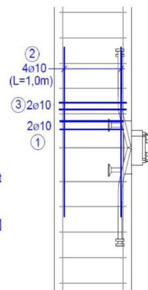
Zusatzbewehrung in Rundstützen ( $d \geq 360\text{mm}$ ):
