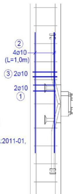
Zusatzbewehrung in Rundstützen ( $280 \leq d < 360\text{mm}$ ):
