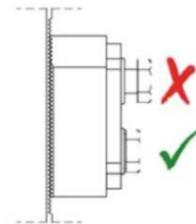
9. Schrauben mind. mit  $T_{inst,min}$  anziehen.  $T_{inst,max}$  darf nicht überschritten werden ( $T_{inst}$  gemäß Anlage 16, Tab.11).
