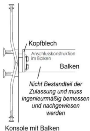
Peikko PCs Konsolle zum Anschluss von Balken an Wände und Stützen
