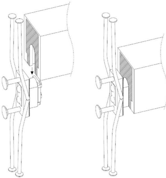
Bild 11: Anschlussträger aufsetzen
