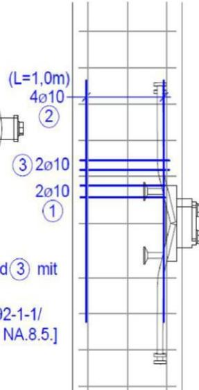
Peikko PCs Konsole zum Anschluss von Balken an Wände und Stützen
