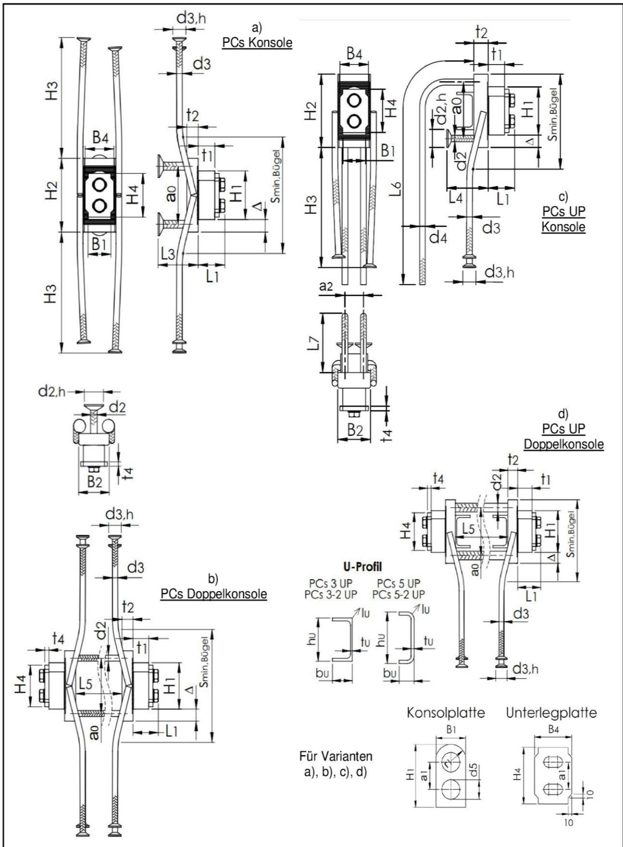
Peikko PCs Konsole zum Anschluss von Balken an Wände und Stützen
