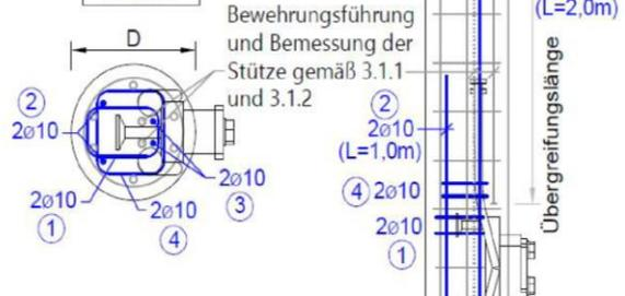
Bügel Pos. ① und ④ mit  $l_0$  - geschlossen
