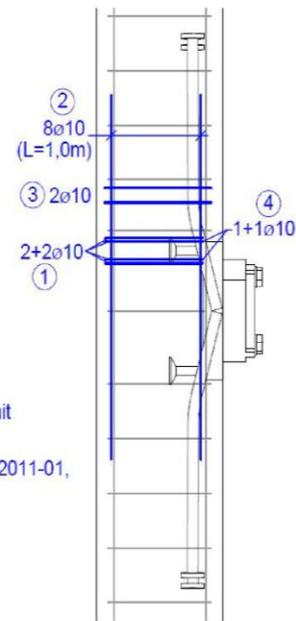
Zusatzbewehrung in Rundstützen ( $380 \leq d < 560\text{mm}$ ):
