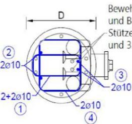
Bügel Pos. ① und ④ mit  $l_b$  - geschlossen
