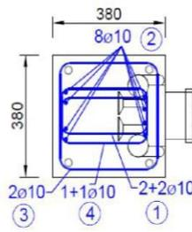
Bügel Pos. ① ③ und ④ mit  $l_b$  - geschlossen
