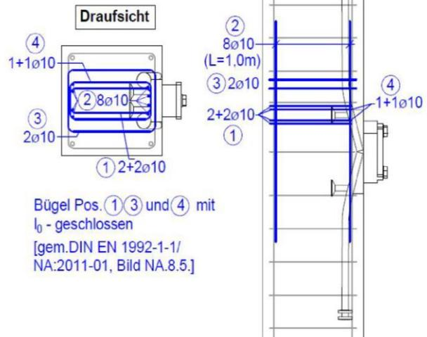
Zusatzbewehrung in Rundstützen ( $d \geq 560\text{mm}$ ):
