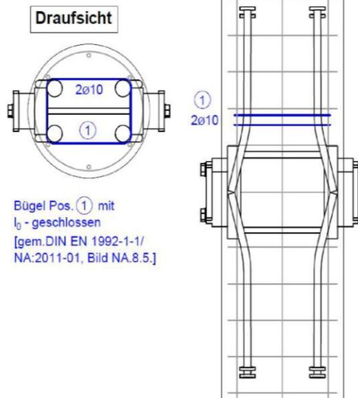
Peikko PCs Konsole zum Anschluss von Balken an Wände und Stützen
