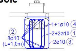
Bügel Pos. ① ③ und ④ mit  $l_0$  - geschlossen
