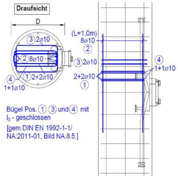
Peikko PCs Konsole zum Anschluss von Balken an Wände und Stützen
