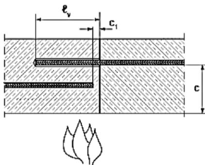
$$N_{Sd,fi} \leq (l_v - c_1) \cdot \phi \cdot \pi \cdot f_{bd,fi} \quad \text{mit} \quad l_s \leq (l_v - c_1) \leq 80 \phi$$
