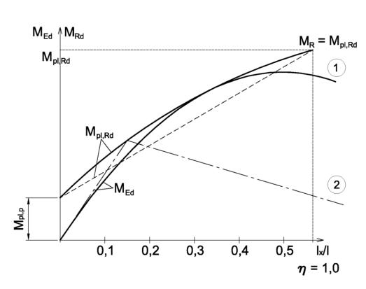
Schubübertragungslänge lsf bei  $\eta = 1,0$ :  $l_{sf} = \frac{A_{pe} \cdot f_{yp,d}}{T_{u,Rd} \cdot b}$
