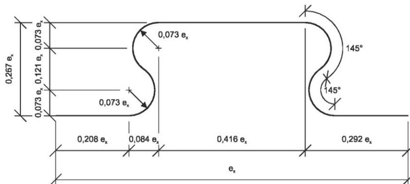
Toleranzen: +2/-4 mm ("+" entspricht einer Vergrößerung des Stahlbauteils)
