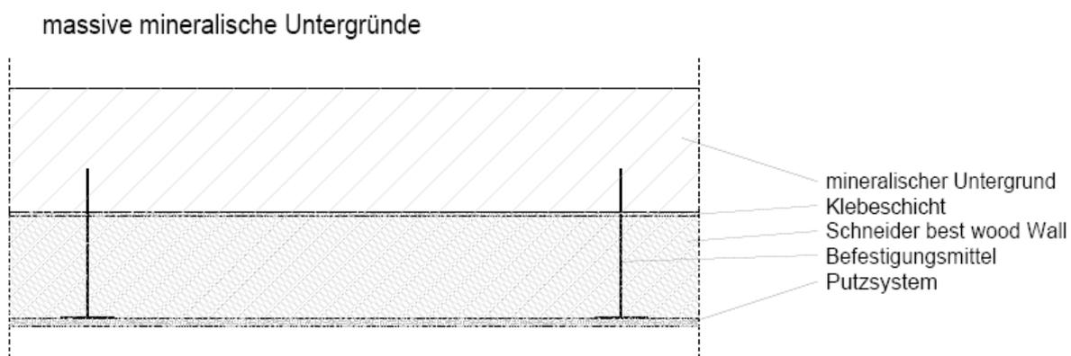
**Aufbau des WDVS "best wood SCHNEIDER® WALL"**
