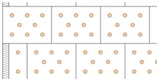
**Mindestanzahl der Dübel** bei charakteristischer Zugtragfähigkeit der Dübel  $N_{Rk}$  im Untergrund für charakteristische Windsoglasten  $w_{ek}$
