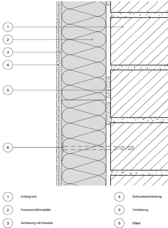
Teilflächenverklebung der Mineralwolle-Lamellen bzw. Mineralwolle-Platten
