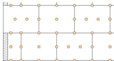
**Mindestanzahl der Dübel** bei charakteristischer Zugtragfähigkeit der Dübel  $N_{Rk}$  im Untergrund für charakteristische Windsoglasten  $w_{ek}$
