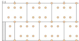
**Mindestanzahl der Dübel** bei charakteristischer Zugtragfähigkeit der Dübel  $N_{Rk}$  im Untergrund für charakteristische Windsoglasten  $w_{ek}$
