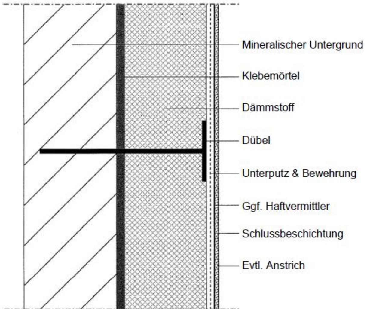
**Aufbau des WDVS "STEICOsecure Mineral"**
