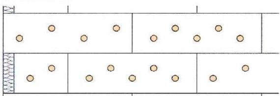
**Mindestanzahl der Dübel** bei charakteristischer Zugtragfähigkeit der Dübel  $N_{Rk}$  im Untergrund für charakteristische Windsoglasten  $w_{ek}$
