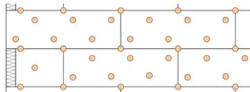
**Mindestanzahl der Dübel** bei charakteristischer Zugtragfähigkeit der Dübel  $N_{Rk}$  im Untergrund für charakteristische Windsoglasten  $w_{ek}$
