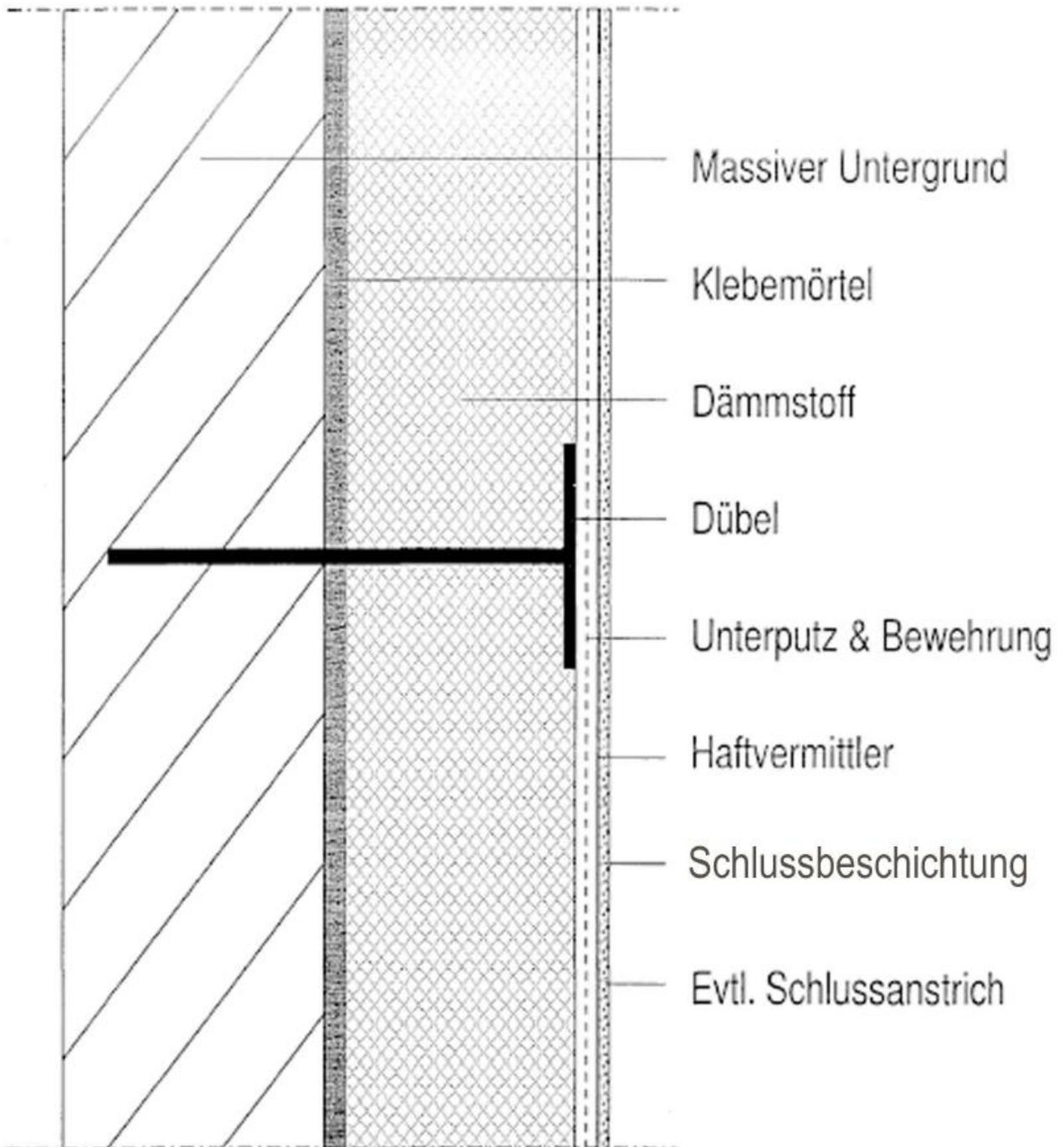
**Aufbau des WDVS "EnergiePlus"**
