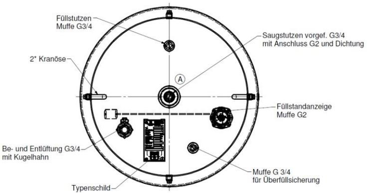
Zylindrische einwandige Lagerbehälter Typ GS 270 E I für wassergefährdende Flüssigkeiten
