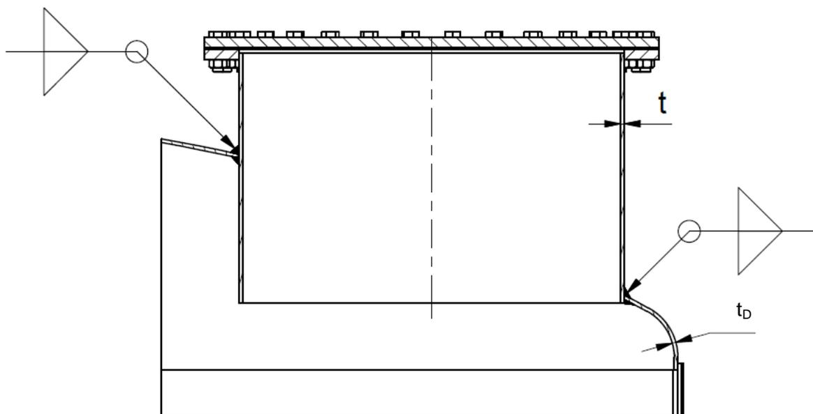
$$a_{\min} \geq (\sqrt{t_{\max}} - 0,5) \geq 3 \text{ mm}$$
