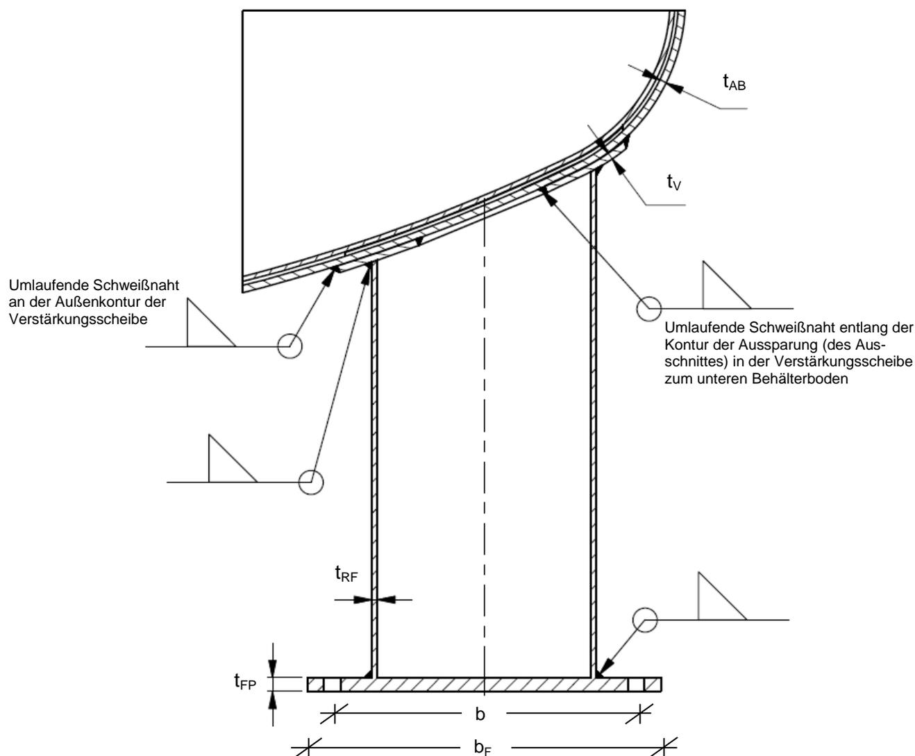
$$a_{\min} \geq (\sqrt{t_{\max}} - 0,5) \geq 3 \text{ mm}$$
