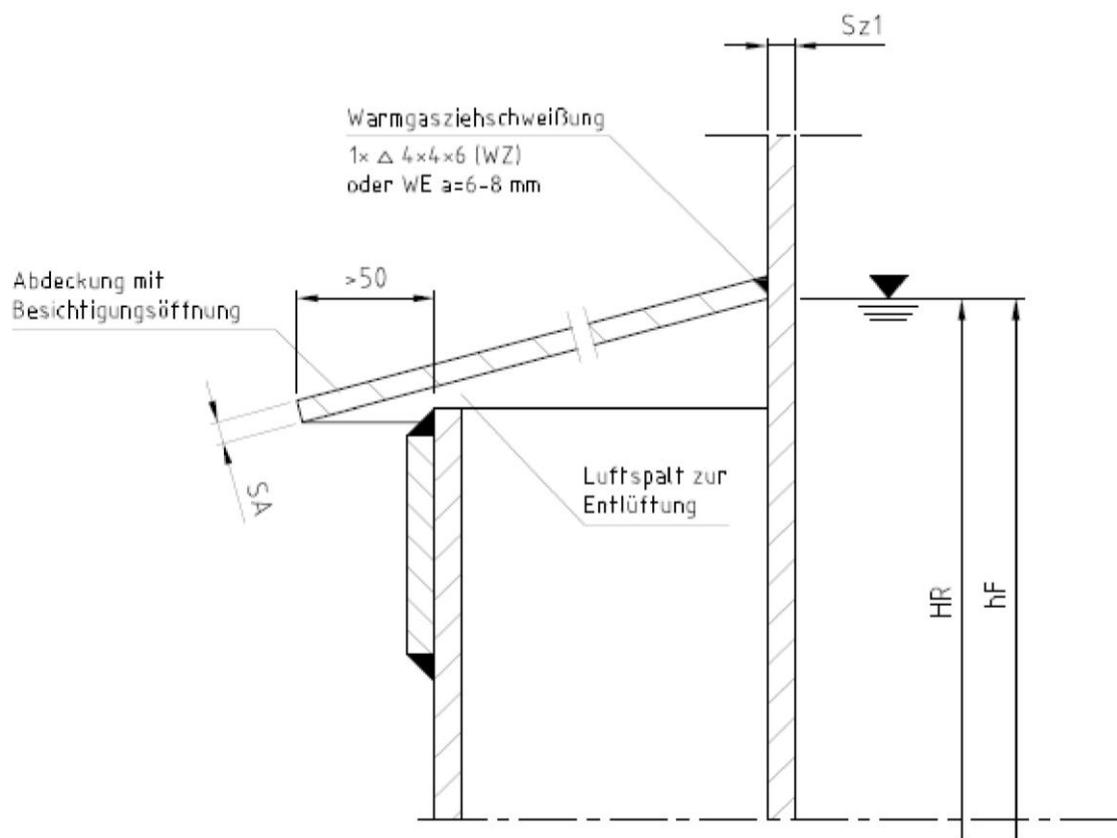
Befestigung des Regenabweisers in Abhängigkeit von hF:
