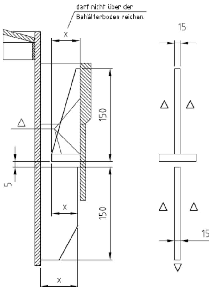
Konstruktive Sicherung des Behälters gegen Aufschwimmen
