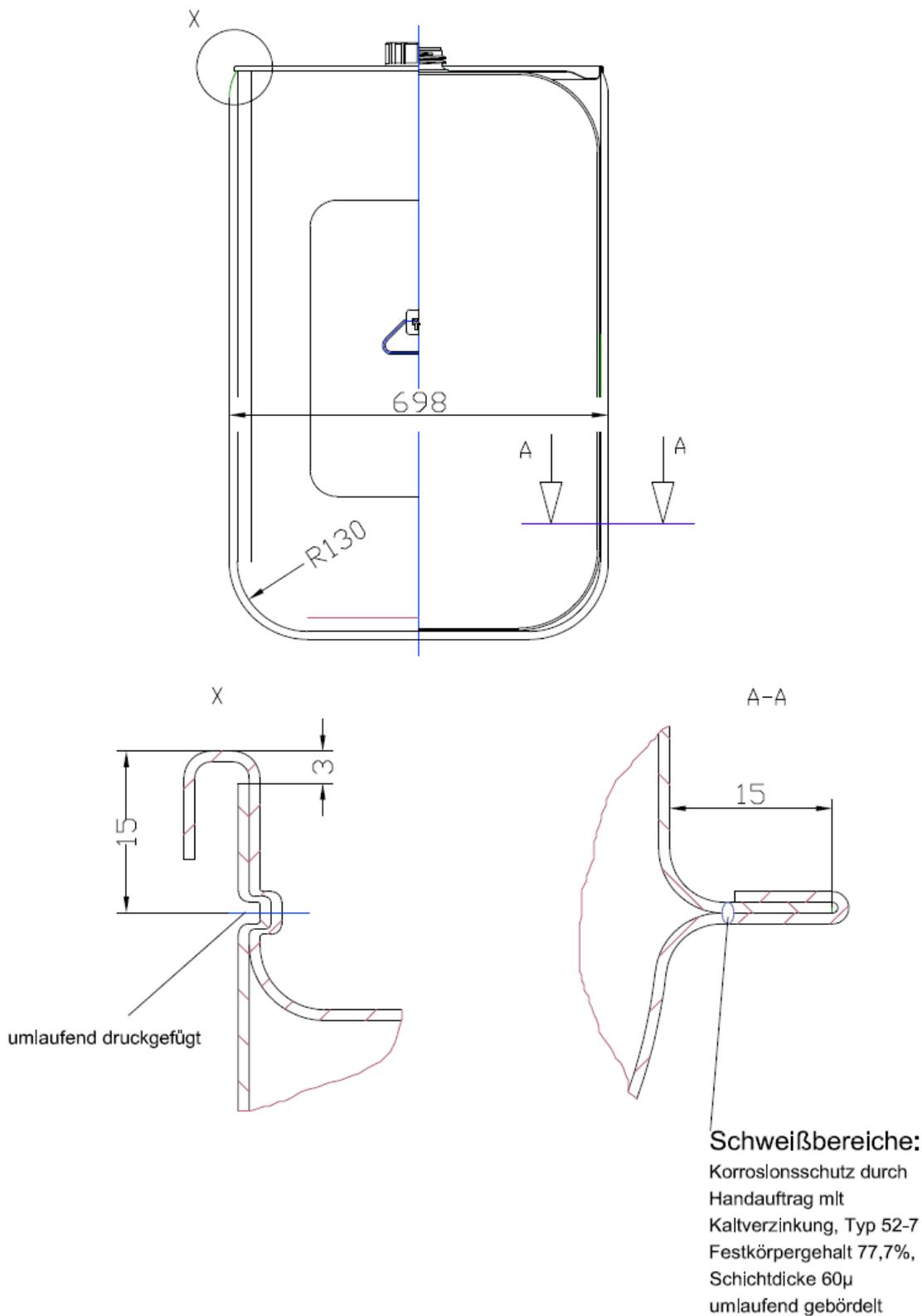
Blasgeformte Behälter aus Polyethylen (PE-HD)
