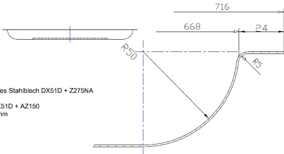
Feuerverzinktes Stahlblech DX51D + Z275NA
