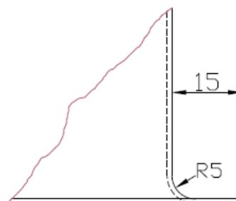
Feuerverzinktes Stahlblech DX51D + Z275NA
