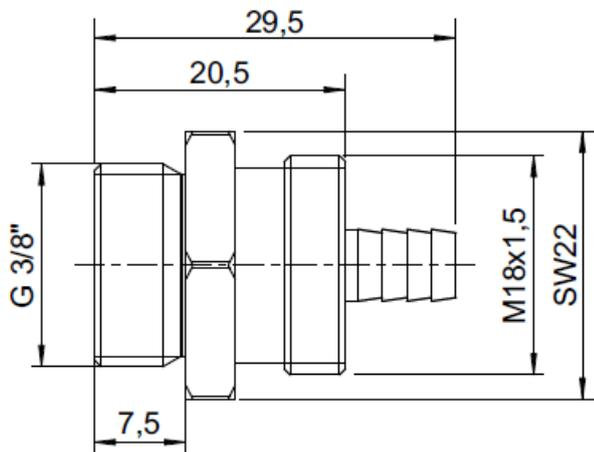
**Pos. 1** Rohranschluß VA-Oil
