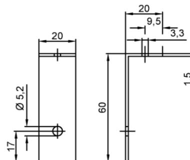
Winkel wird beim Einbau in klassifizierte Zwischendecken, Schachtwände und feuerwiderstandsfähigen Leitungen benötigt.
