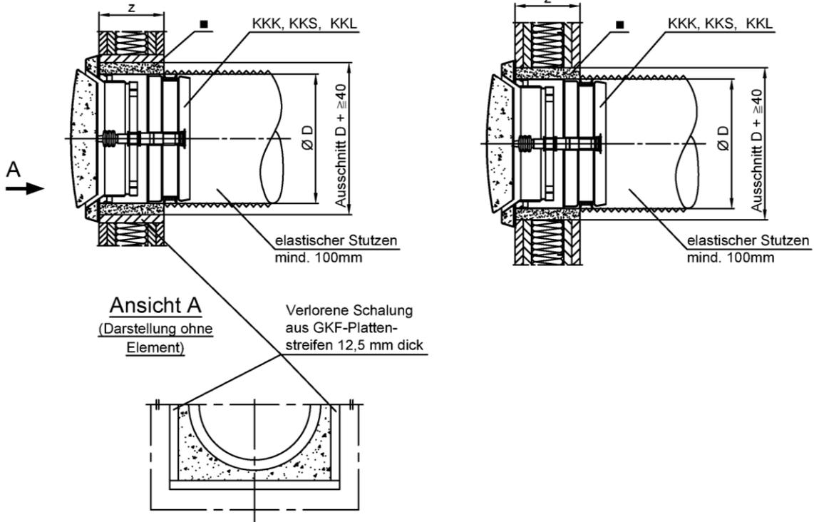
Einbau in leichte Trennwand F30, F60 oder F90 (Trockeneinbau)
