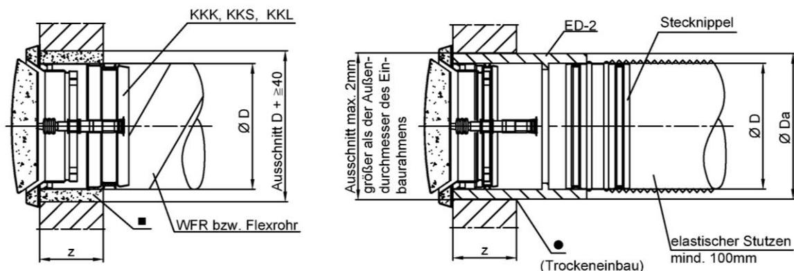
Einbau in Decken F30, F60 oder F90 aus Beton bzw. Porenbeton
