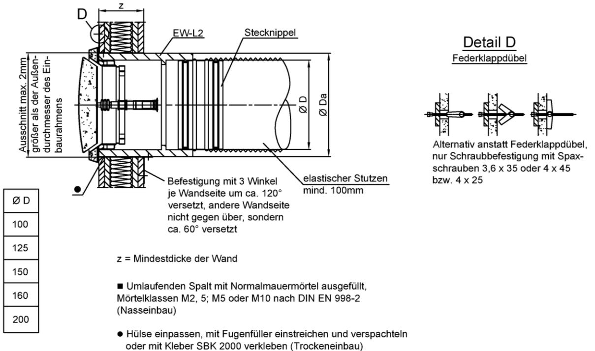
Absperrvorrichtungen gegen Feuer und Rauch in Lüftungsleitungen vom Typ BCF-2
