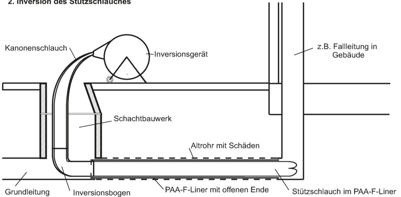
Schlauchliner mit der Bezeichnung „PAA-F-Liner“ zur Sanierung schadhafter erdverlegter Abwasserleitungen im Nennweitenbereich von DN 100 bis DN 250 mit LED Lichthärtung
