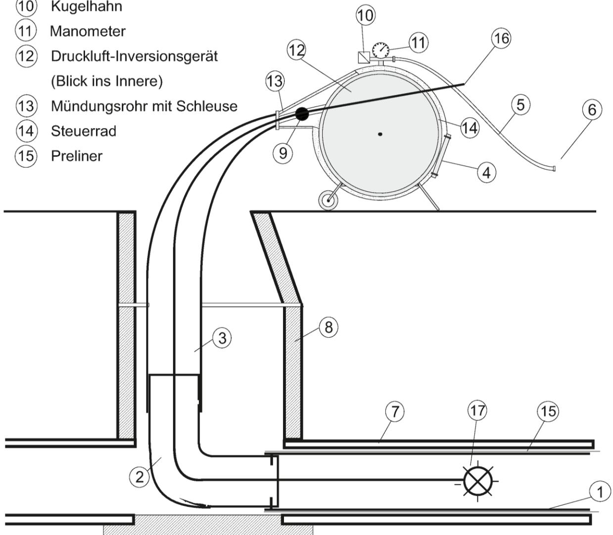
Schlauchliner mit der Bezeichnung „PAA-F-Liner“ zur Sanierung schadhafter erdverlegter Abwasserleitungen im Nennweitenbereich von DN 100 bis DN 250 mit LED Lichthärtung
