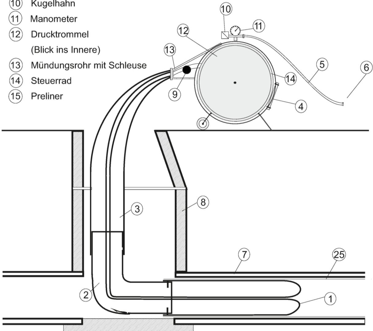
Schlauchliner mit der Bezeichnung „PAA-F-Liner“ zur Sanierung schadhafter erdverlegter Abwasserleitungen im Nennweitenbereich von DN 100 bis DN 250 mit LED Lichthärtung
