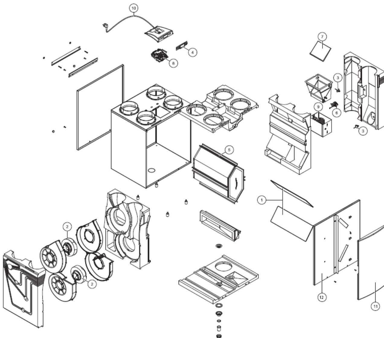
**Explosionsdarstellung des Lüftungsgerätes**
