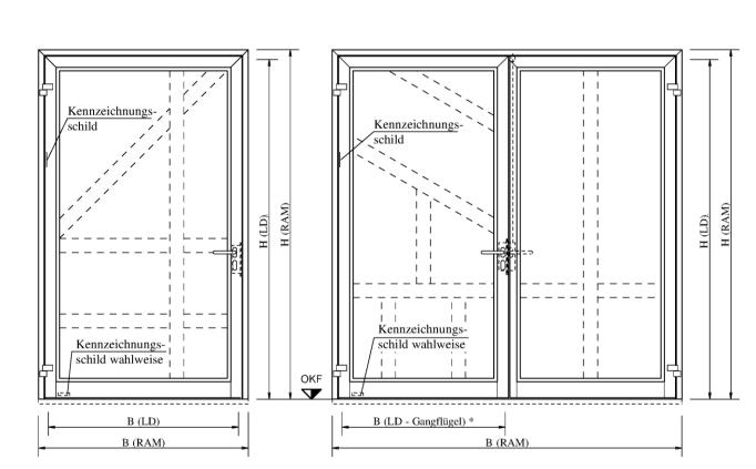
\* Bei Verwendung eines Falztreibriegels steht der LD-Gangflügel nur als Rettungsweg zur Verfügung. Dieses Maß verringert sich bei einem Öffnungswinkel von nur 90 Grad.
