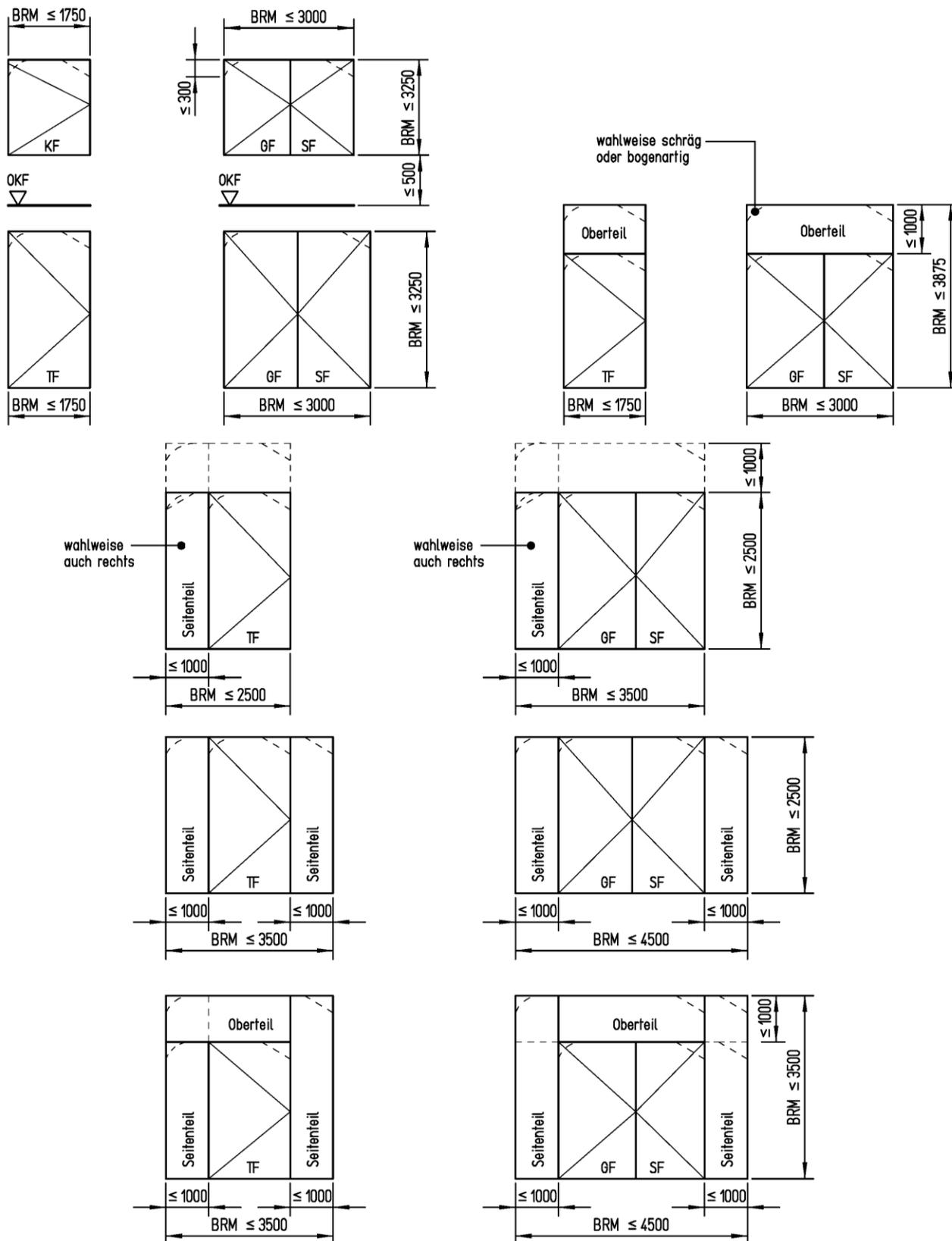
T 90-1-FSA "neuform-Typ SUPRA" bzw. T 90-1-RS-FSA "neuform-Typ SUPRA" bzw.
