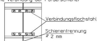
Detail A (mechanische Verbindung der Förderschiene)
