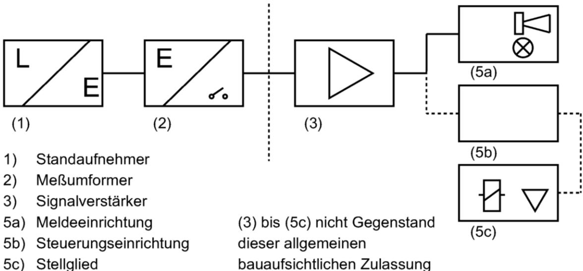
Standaufnehmer (Verdränger) mit angebautem Messumformer als Standgrenzschalter von Überfüllsicherungen
