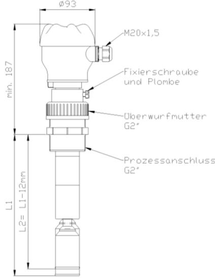
**Schema der Überfüllsicherung**
