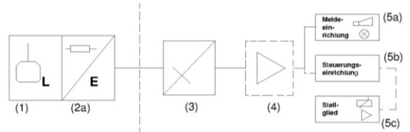
Standaufnehmer mit integriertem Messumformer (2a) mit Strom-Ausgang
