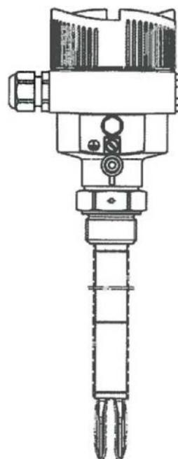
**Schema der Überfüllsicherung**
