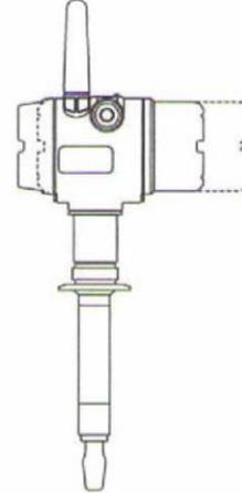
**Schema der Überfüllsicherung**
