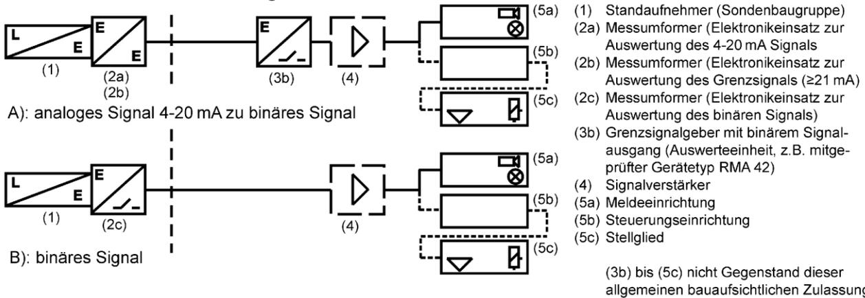
Standaufnehmer (Verdränger) "Proservo NMS8..." mit integriertem Messumformer als kontinuierliche Standmesseinrichtung von Überfüllsicherungen
