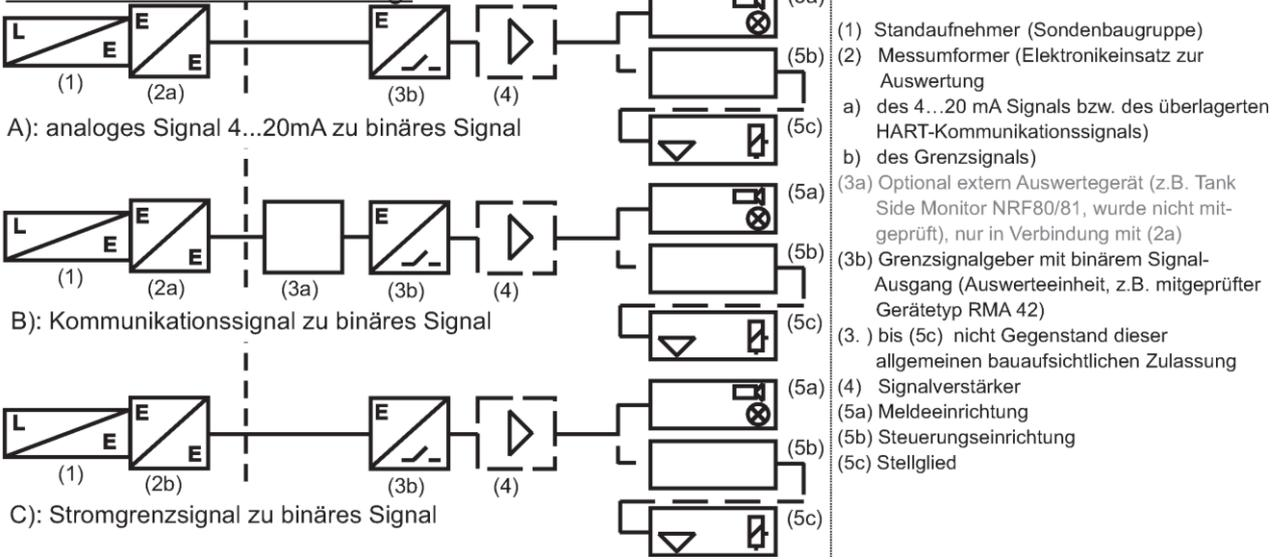
Standaufnehmer (Radar-Antenne) "Micropilot FMR6..." mit integriertem Messumformer als kontinuierliche Standmессeinrichtung von Überfüllsicherungen
