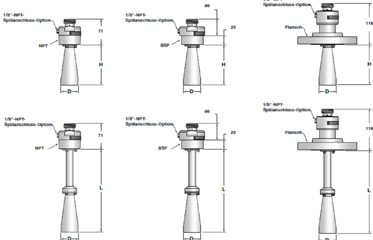
Standaufnehmer (Radar-Antenne) Typ "RB..." mit integriertem Messumformer Typ "R86-5..." als kontinuierliche Standmesseinrichtung von Überfüllsicherungen
